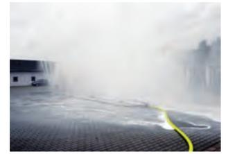
*Die Dichtheit der “Wasserwand” im Vergleich. Links, der Einsatz mit klarem Wasser. Beim Betrieb mit Netzwasser (Bild rechts – 0,3% Class-A-Schaummittel), werden die Tröpfchen deutlich feiner bei vergleichsweise geringem Wurfhöhenverlust. Es tritt eine Vernebelung ein, die dann auch den Durchtritt von Wärmestrahlung sehr stark behindert. Jedoch steigt auch die Windabhängigkeit der “Wasserwand”.*
